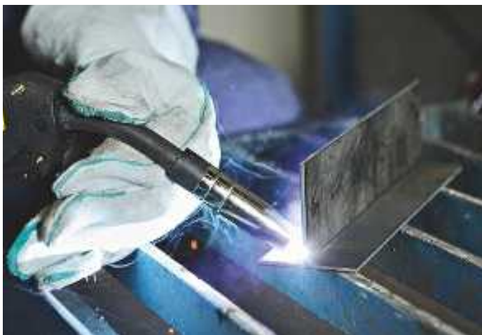
Vertailun aikana hitsattiin vain niin sanottua mustaa rautaa, vaikka jopa alumiinin hitsaaminen olisi ollut joillain vertailukoneilla mahdollista. Testihitsauksissa ainevahvuudet vaihtelivat yhdestä viiteen millimetriin.
